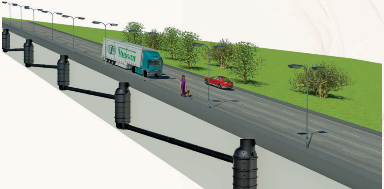
Slika 11. Prikaz korištenja kaskadnih okana
