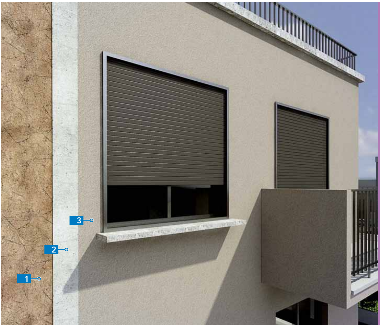
Sanacija mikro pukotina na fasadnim površinama sa završnim premazom
