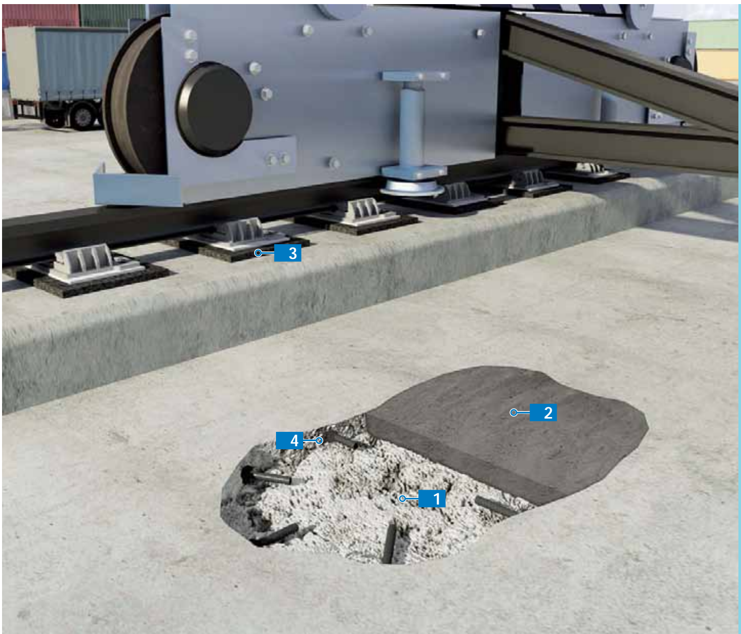
Sanacija betonskih podova i sidrenje tračnica nadzemnih mostnih dizalica
