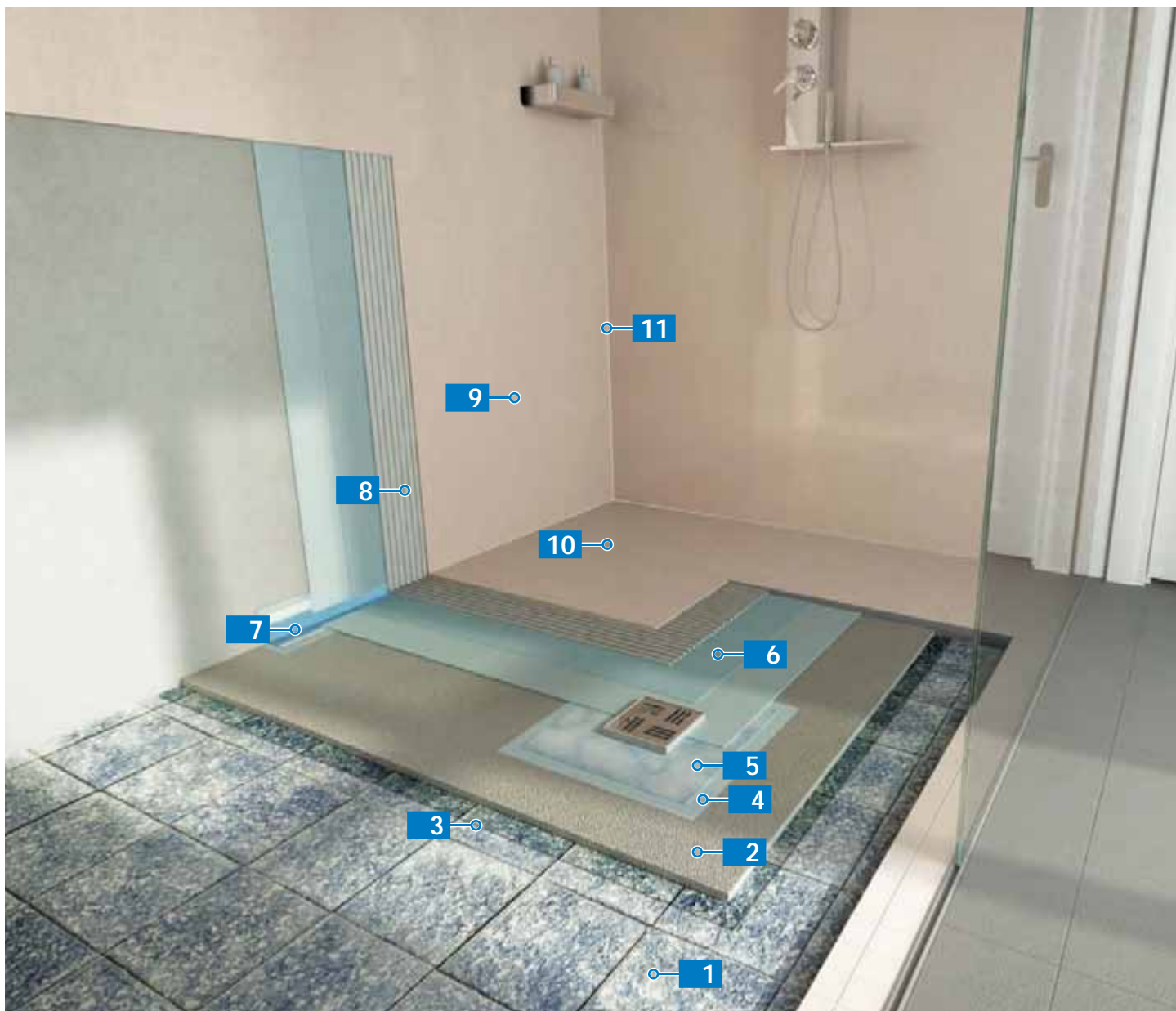
Adaptacija kupaonice primjenom sustava za hidroizolaciju i polaganje staklenog mozaika
