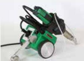
**Unglaublich schnell:** Trotz seines geringen Gewichts bietet der MINIFLOOR eine Schweissgeschwindigkeit von rund 2 m/min, was nahezu einer Verdoppelung gegenüber der Schweissgeschwindigkeit beim Handschweißen entspricht.
