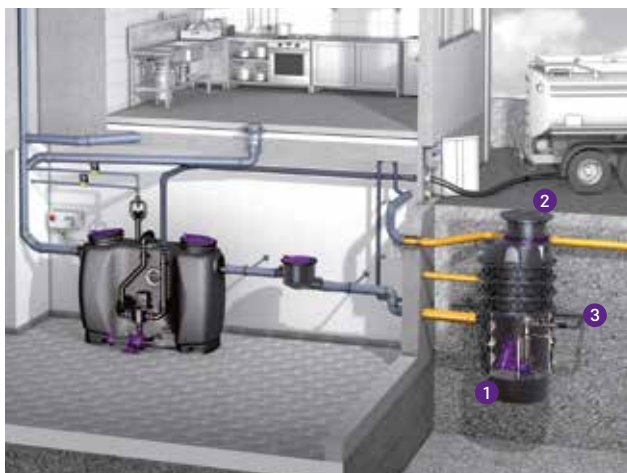
1 Crpna stanica 2 Tehnička komora 3 Tlačna cijev
