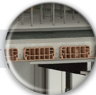
Ojačanje podne konstrukcije dodavanjem krutog sloja morta PLANITOP HPC FLOOR.
