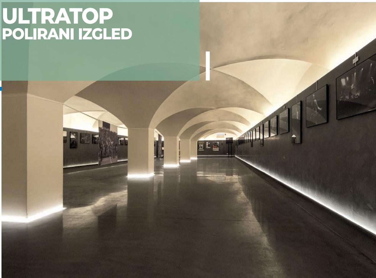
Samoizravnavajući brzosušće cementni sustav za podove otporne na abraziju, poliranog izgleda; debljine od 10 do 40 mm.
