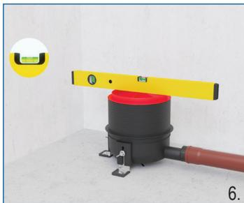
DE Ablaufkörper mit Ablaufleitung verbinden, Rohrgefälle über die Befestigungswinkel in der Höhe einstellen.
