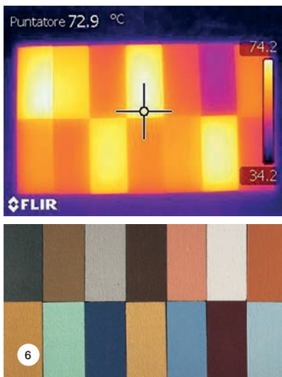
SLIKA 6: Ilustracija površine sa završnim slojevima različitih boja i različite temperature koje dosežu površine izložene istim razinama zračenja.
